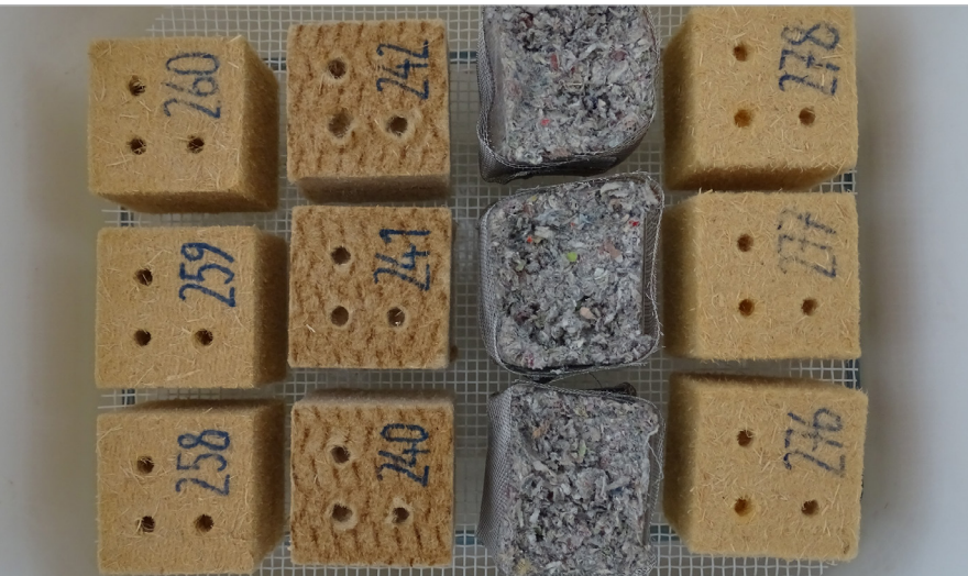
Dämmstoffprobekörper für den Dauerhaftigkeitsversuch
