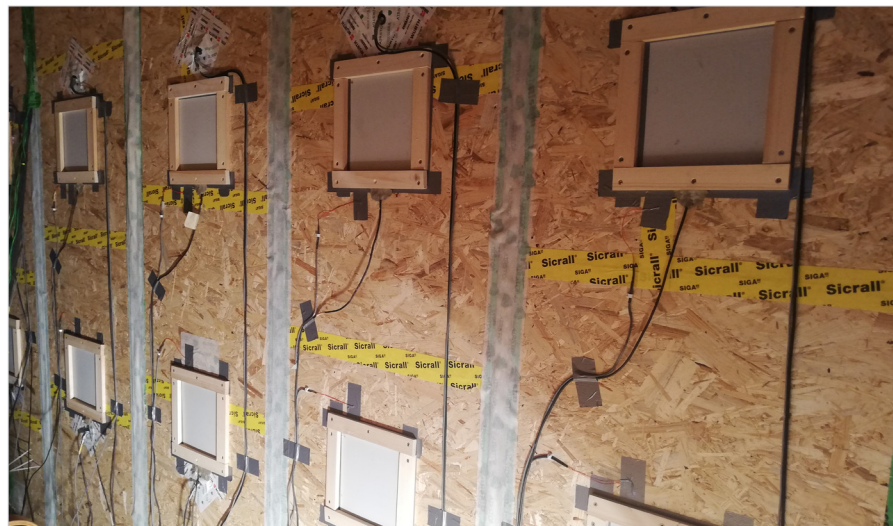
In situ Wärmestrommessung am HFA-Forschungshaus
