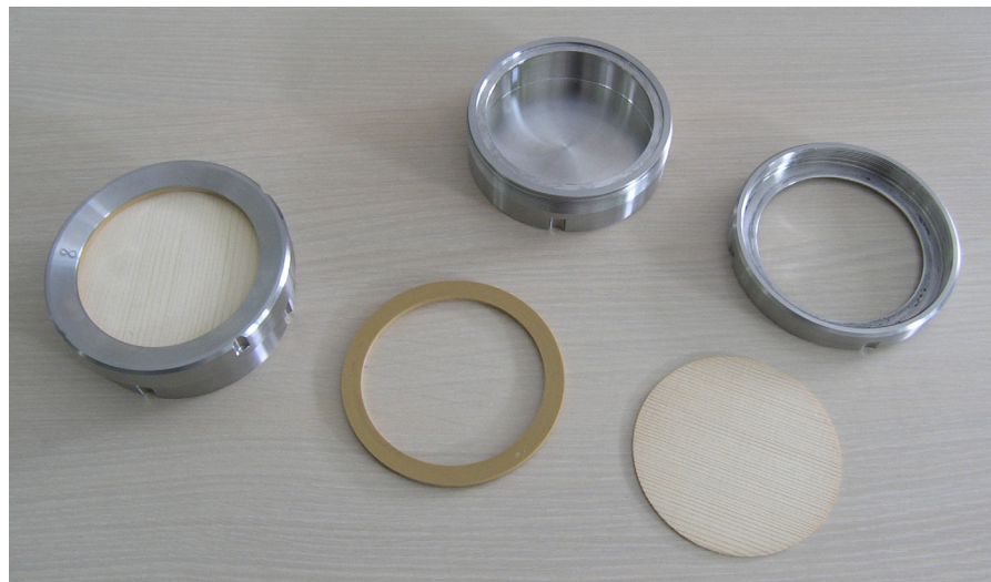
Messung der Wasserdampfdurchlässigkeit an Holzplättchen mit Prüfdosen
