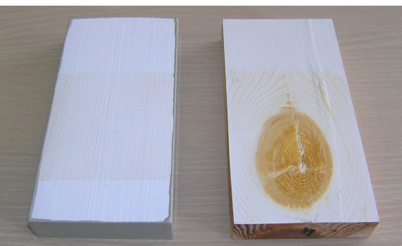
Durchschlagen von Holzinhaltstoffen und Ästen durch weiße Beschichtungen
